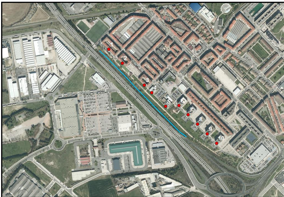
Ilustración 57. Barrera acústica planteada en el Plan Zonal 10 – Berriozar
